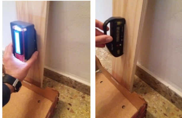
Figura 5: Calibración del Dispositivo 1 (izqda.) con inclinómetro (dcha.).
